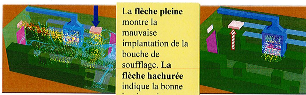
Figure 1 : Influence de l'implantation des bouches de soufflage sur le fonctionnement d'une sorbonne (d'après étude NIH)
